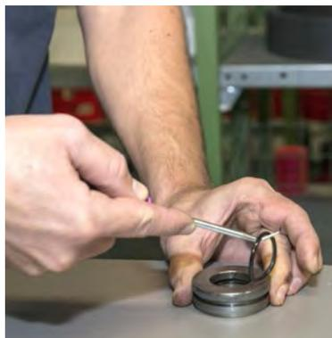
**Mit dem prämierten Werkzeug ist die Demontage von Dichtungen ohne die Gefahr einer Verletzung der Hände möglich.**
