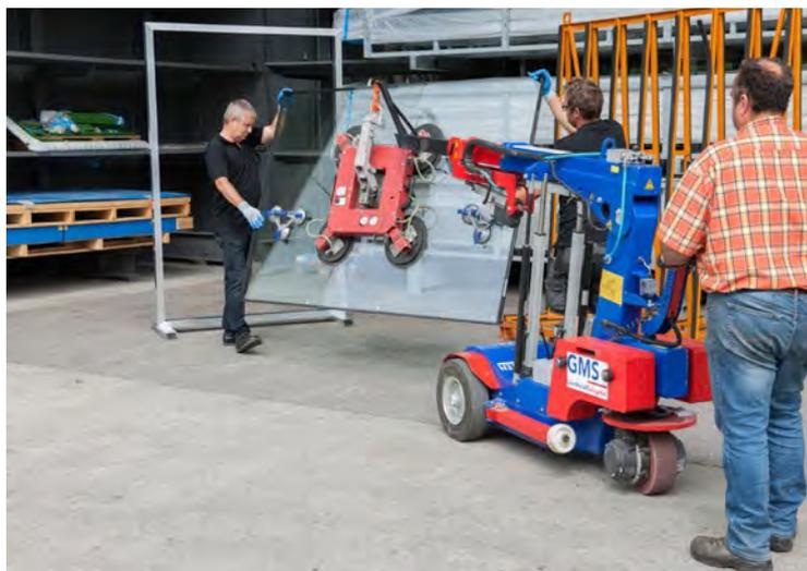
Mit dem Glasroboter lassen sich große Glasflächen ohne enorme körperliche Belastungen von innen manipulieren und verbauen.
