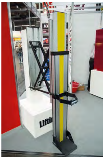
Mobile Hebeeinrichtung für Sauerstoffflaschen: In kürzester Zeit einsatzbereit.
