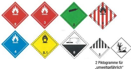
Abbildung 4: Zum Vergleich anbei noch die Gefahrzettel bzw. Placards der stofflich relevanten Gefahrgutklassen, die bei größeren Verpackungseinheiten zur Kennzeichnung im Gefahrgutrecht anzuwenden sind, in analoger Reihenfolge wie bei obigem Kennzeichnungsvorschlag
