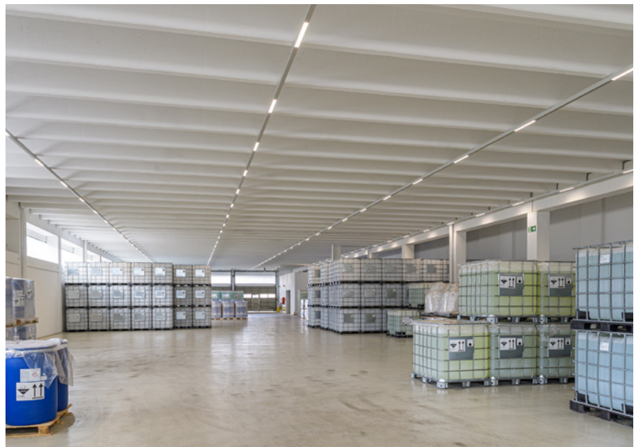
Wände und Boden der Gefahrstoff-Lagerhalle wurden heller gestrichen und die Beleuchtung erneuert. Das hat die Arbeits- und Sehbedingungen verbessert.
