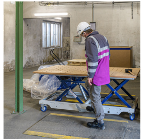
Am Scherenhubtisch lässt sich die Arbeitshöhe an die individuelle Körpergröße anpassen.
