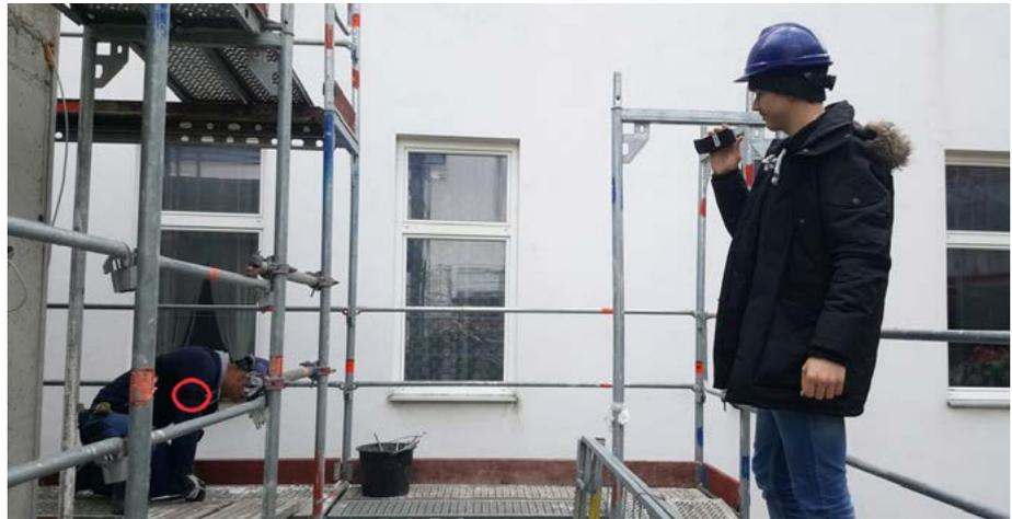
Abbildung 5: Hier wird die Arbeit des Gerüstbauers zusätzlich mit einer Videokamera aufgezeichnet. In dem roten Kreis ist ein Beschleunigungssensor, mit einem Gurt über dem Brustbein angebracht, sichtbar.
