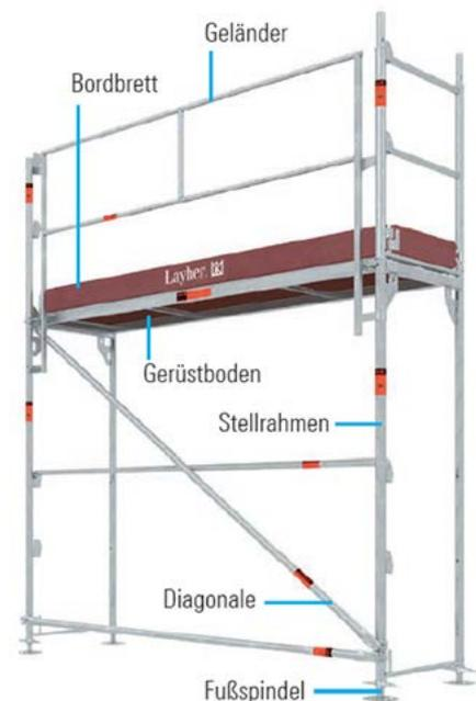
Abbildung 2: Hier ist das Layher „Blitz-Gerüst“ mit den einzelnen Komponenten abgebildet. Vier Fußspindeln, eine Diagonale, zwei Stellrahmen, ein Gerüstboden, ein Bordbrett und vier Geländer werden benötigt, um das Layher Blitz-Gerüst aufzubauen.
